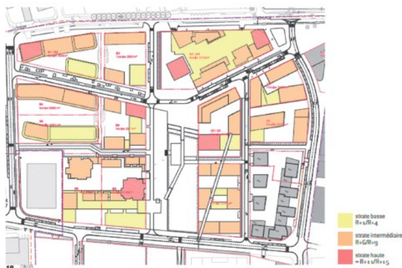
Figure 165 : Principe de strates pour l'organisation volumétrique
