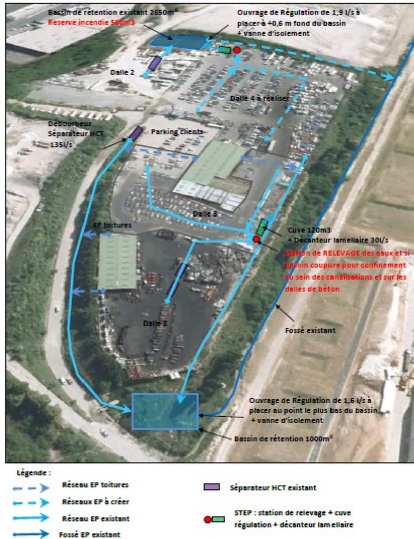
Illustration 5: Schéma des écoulements d'eaux pluviales existants et projetés à terme (annexe 29 du dossier)
