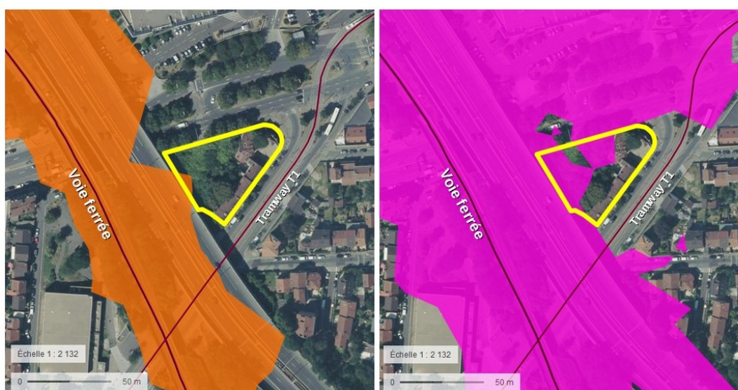
Illustration 7: Nuisances sonores de la voie ferrée de grande ceinture - Carte des dépassements des valeurs réglementaires sur 24 h (indicateur Lden, niveaux supérieurs à 73 dB(A), carte de gauche) et en période nocturne (indicateur Ln, niveaux supérieurs à 65 dB(A), carte de droite) – source : Bruitparif, Géoportail, annotations : DRIEE
