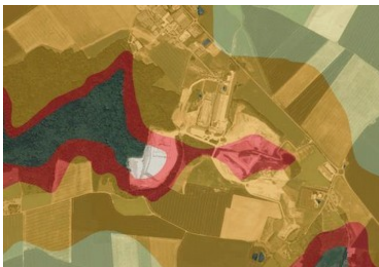
Figure 11: Carte de l'aléa retrait gonflement des argiles présentée dans le dossier. Source Volet IV A - Étude d'impact - État initial
