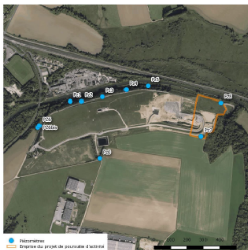
Figure 7 : localisation des piézomètres de contrôle
