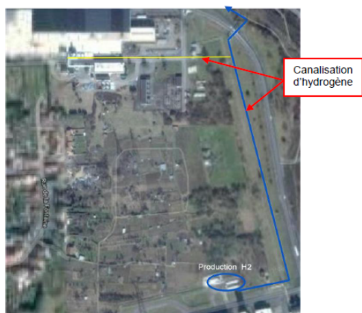
Photo B6 – Cheminement de la canalisation d'hydrogène
