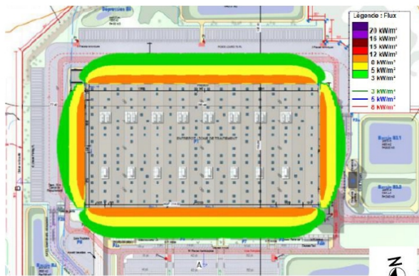
Plan des zones de danger - effets thermiques en cas d'incendie généralisé de l'entrepôt
