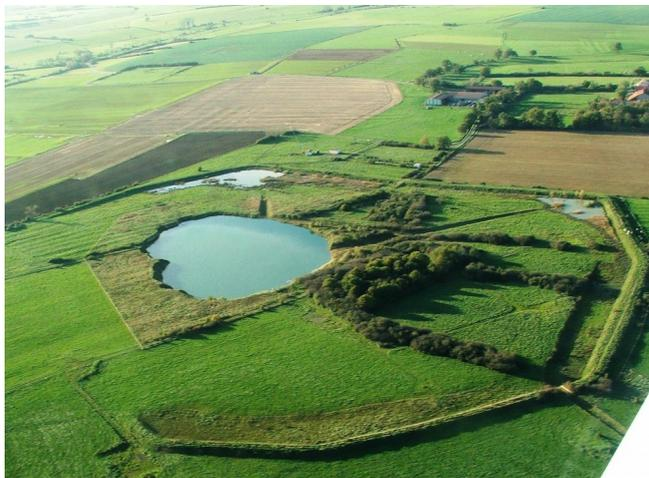
**Photo 1 : Champ d'exploitation de Gellenoncourt. Au centre l'effondrement de 1998**
