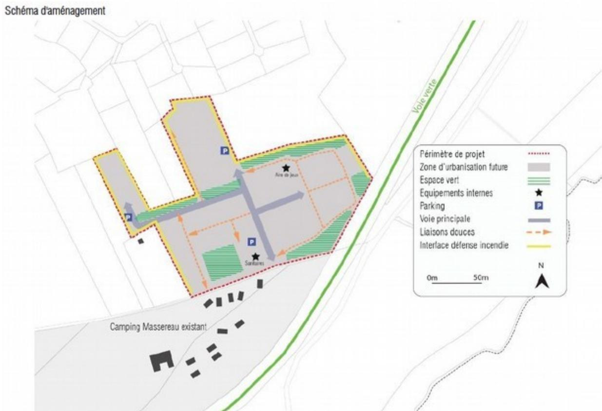
Figure 2 : schéma d'aménagement du projet d'extension du camping Massereau (extrait du dossier II.3 Orientation d'aménagement et de programmation du secteur Massereau)
