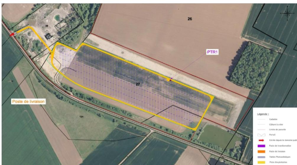
La puissance totale de production prévue est de 4 977 kWc<sup>1</sup>, soit une production annuelle de 6 330 MWh.
