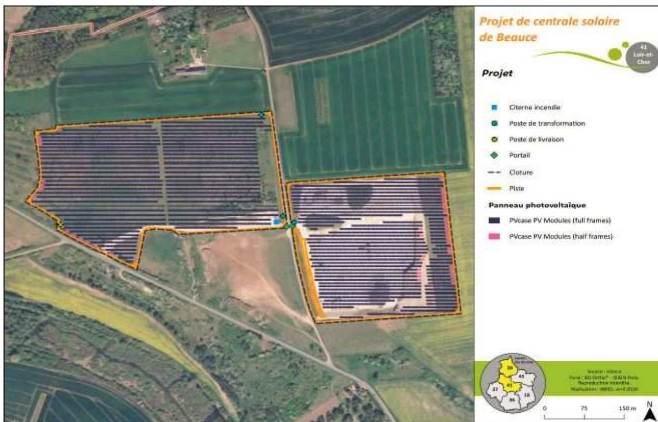
Carte 26 : Plan d'implantation du projet photovoltaïque de Beauce-la-Roche sur friches carbonées et sites cadastres (Mère d'Église, données IGN)
