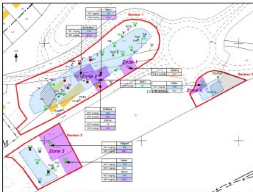
Figure 7 – plan des sondages de pollution des sols En violet : zones de pollutions concentrées en bleu : emprise au sol des bâtiments
