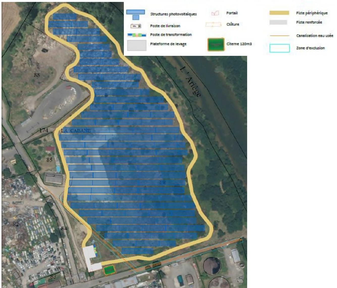
Le poste source le plus proche, envisagé pour le raccordement de ce projet de centrale est celui d'Auterive (la Mouillonne) distant d'environ 4,5 km. Ce raccordement suivra les pistes existantes.
