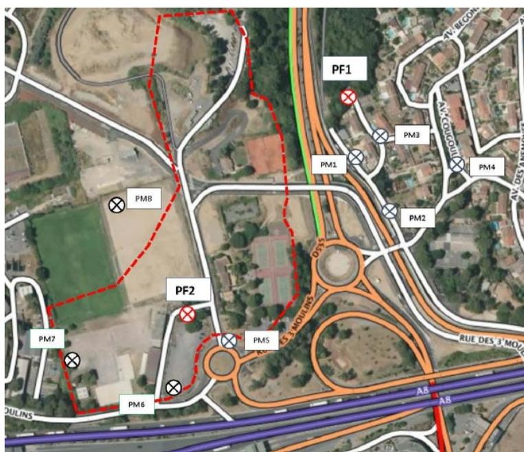
Figure 5: Positionnement des points de mesures acoustiques : points fixes (PF) et mobiles (PM). Source : étude d'impact.
