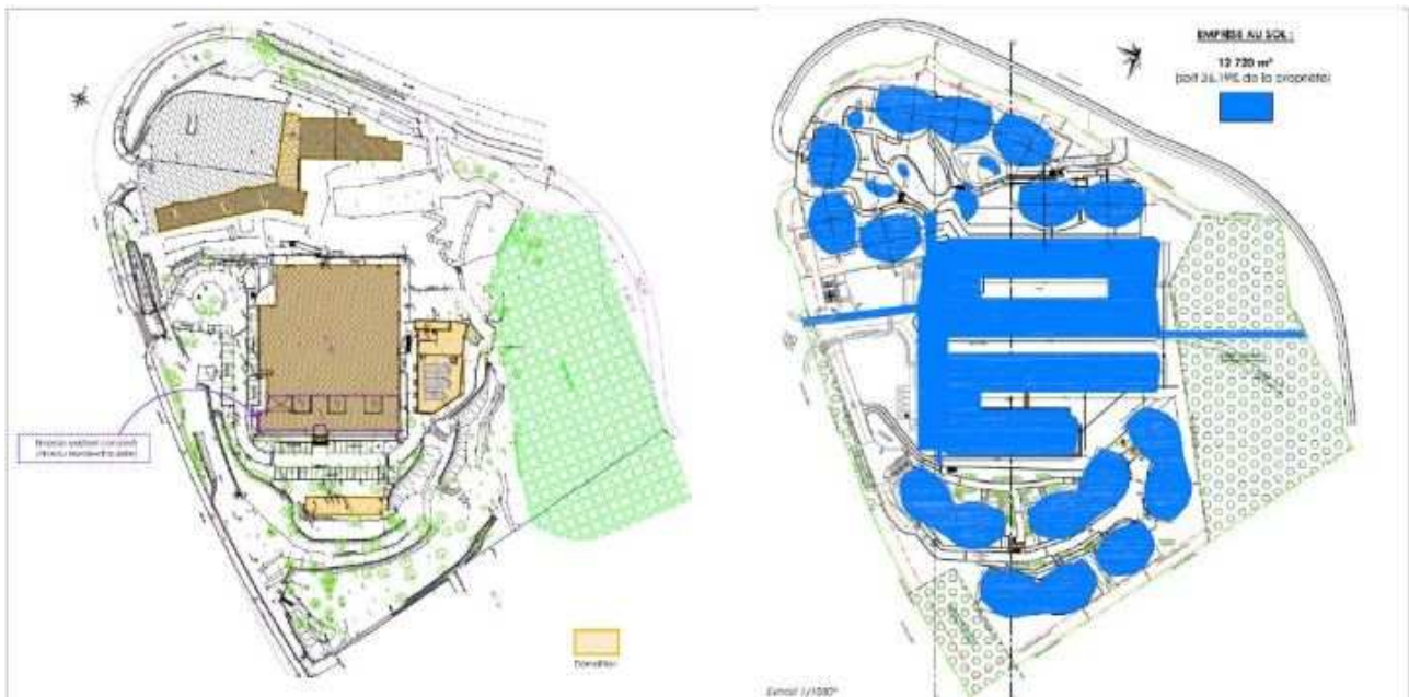
Figure 3: plan des démolitions (à gauche) et emprise au sol du projet (à droite). Source : étude d'impact. Montage réalisé par la MRAe.
