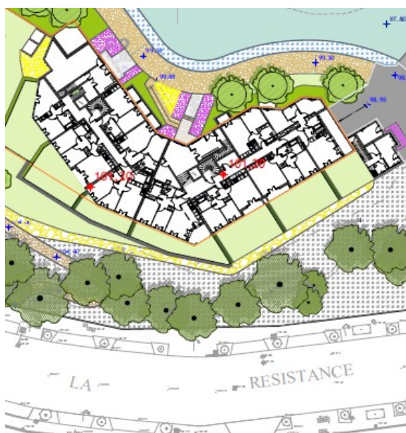
Figure 4 : Plan du rez-de-chaussée des bâtiments F2-F1 exposés au trafic de l'avenue de la Résistance, comprenant des appartements mono-orientés, source : permis de construire, extrait du « plan de masse paysager » (PC2)
