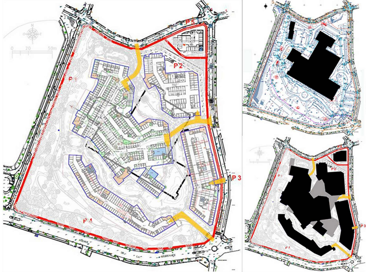
Figure 3: À gauche : implantation des parkings en sous-sol (source : étude d'impact, p. 110).
