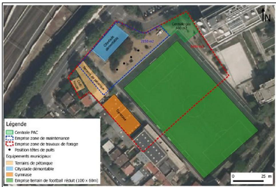
Figure 108 – Maquettage de la parcelle pour forages et centrale géothermique
