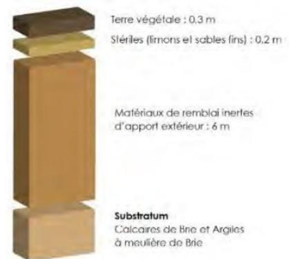
Figure 6: Coupe schématique des terrains remblayés (étude d'impact, p.287)
