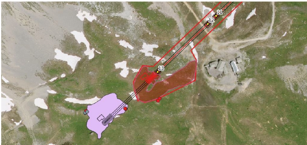
Figure 3: Terrassement G2 amont abandonné (en violet) et nouveau positionnement retenu (en rouge) afin de préserver les stations de Koelérie du Mont Cenis (rond rouge) et de Saxifrage fausse diapensie (rond gris) - Source : étude d'impact
