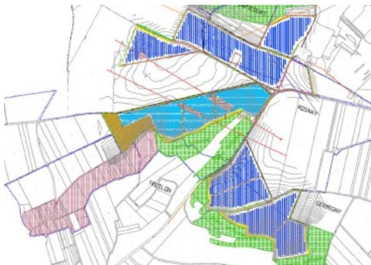
**Figure 4 - plan du projet (trackers en bleu foncé et panneaux au sol en bleu clair)**
