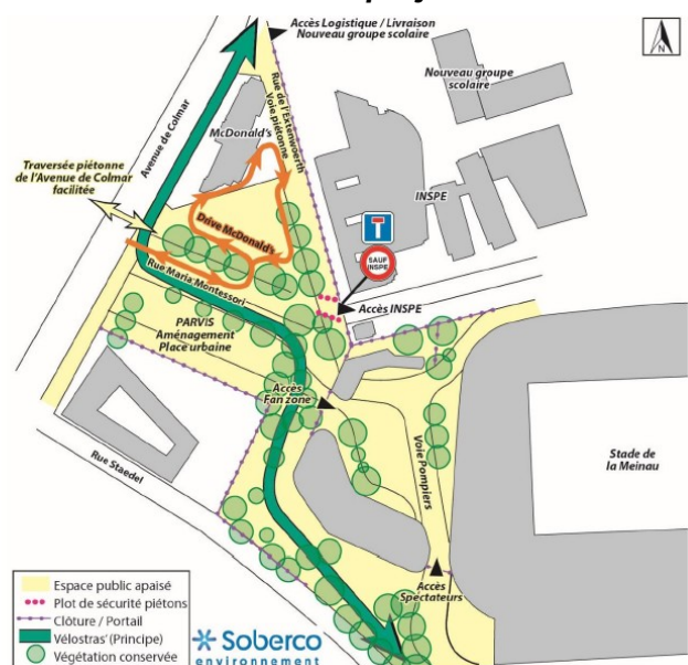
Figure 8 – plan de fonctionnement du parvis
