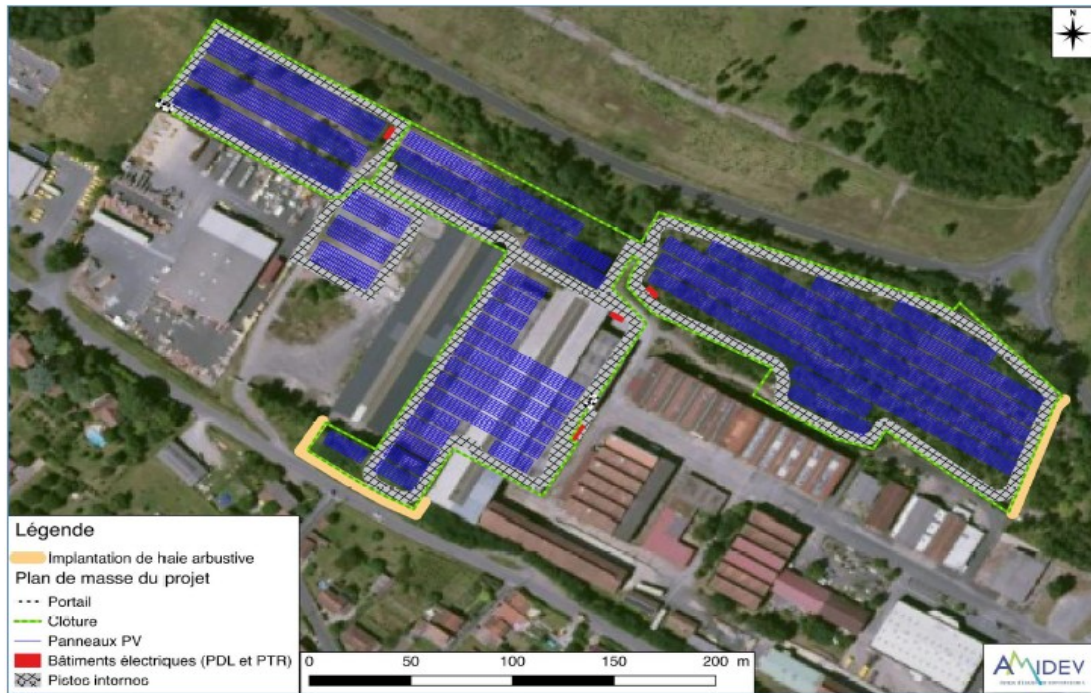
Figure 1: Plan de masse du projet de centrale photovoltaïque au sol et ombrières photovoltaïques (extrait de l'étude d'impact)
