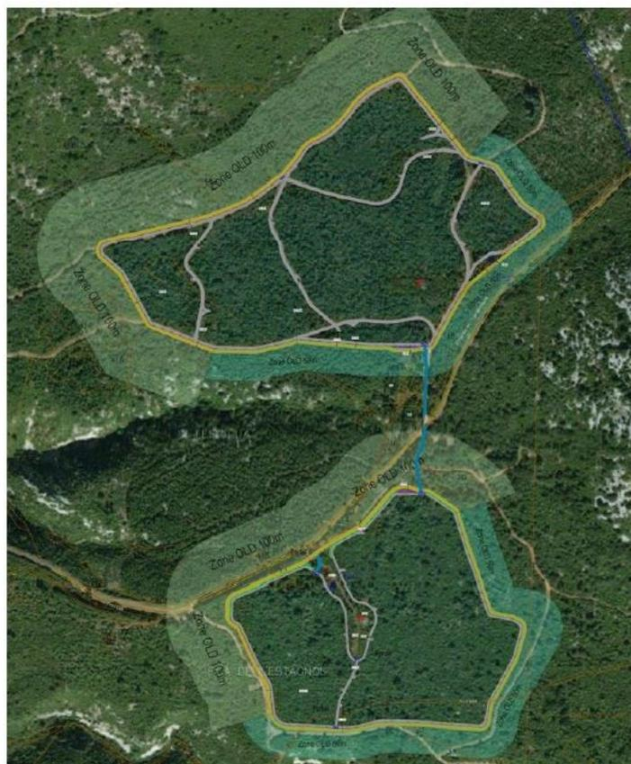
Figure 74 - Plan masse du projet avec application des OLD de 100 et 50 mètres
