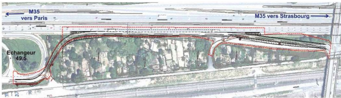
Figure 8: Ajout d'une bretelle sur l'échangeur de Hoenheim
