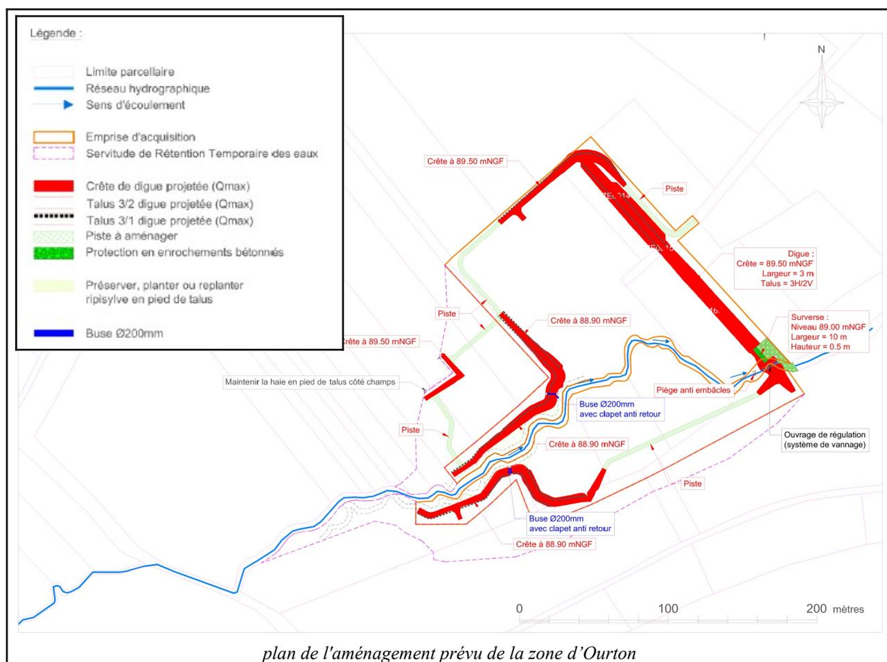
La zone d'expansion de crue sera constituée d'une digue de 281 mètres de longueur et 3,87 mètres de hauteur par rapport au point le plus bas dans le lit mineur ; un ouvrage de régulation sera installé sur le cours d'eau, en haut de digue. La surverse de 10 mètres de largeur est dimensionnée pour une crue centennale. En amont de la zone d'expansion de crue seront également réalisés 300 mètres de remblais intérieurs, d'une hauteur de 1,20 mètres par rapport à la berge.
