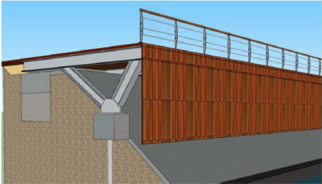
Illustration des travaux de « verticalisation » du perré quai des Voiliers (source : dossier)
