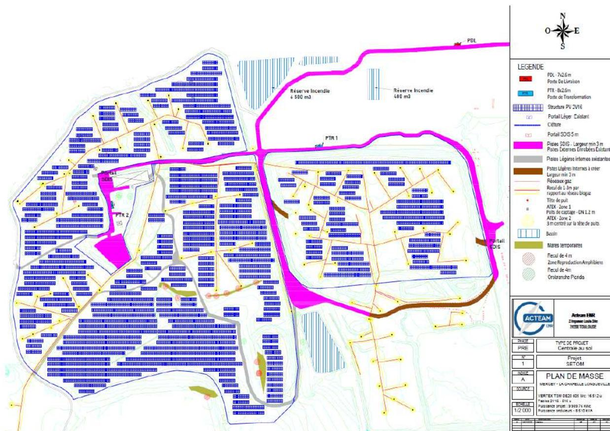
Figure 2: Plan masse du projet de parc photovoltaïque (source : Étude d'impact p. 192)
