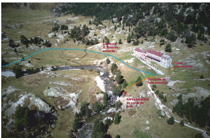
Figure 3 : tracé de la conduite d'eau à l'arrivée au refuge et de la sortie vers l'exutoire dans le gave de Bastans
