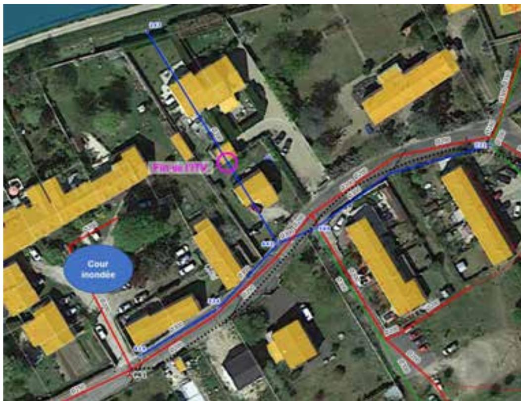
Figure 2.9 : ITV réalisées sur les collecteurs EP de la rue de la Boissière
