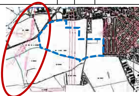
Canalisations de gaz à proximité du site – Source : PLU de Roissy-en-Brie – Extrait du plan des Servitudes d'utilité publique
