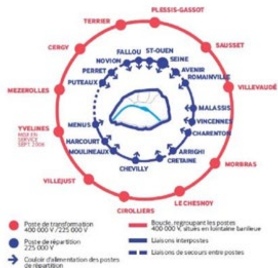
Représentation schématique du réseau électrique en Île-de-France en 2020 (source RTE)
