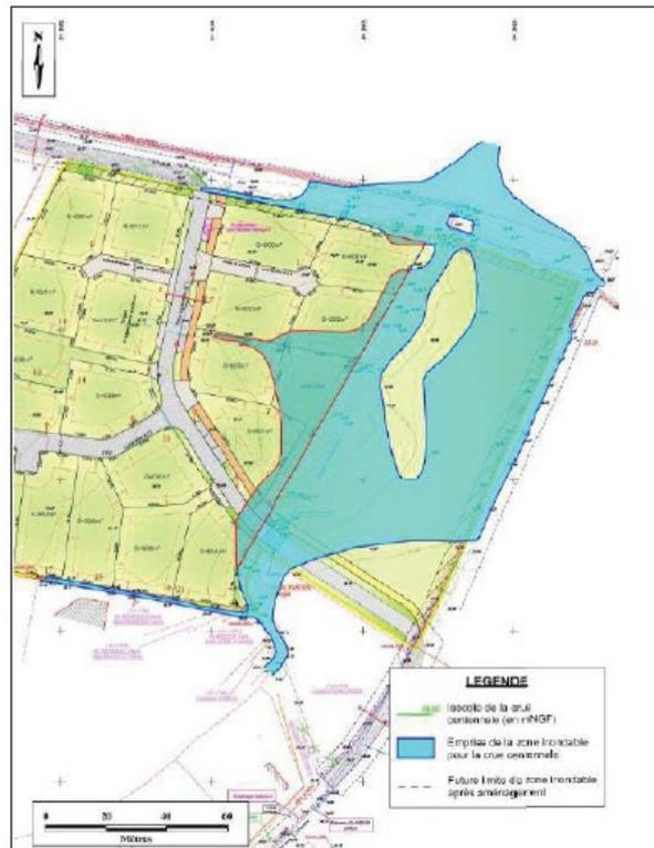
Figure 75 : Emprise de la zone inondable centennale (en bleu) et superficie de la zone remblayée (en orange) au niveau de la rive gauche (Source : ARTELIA)
