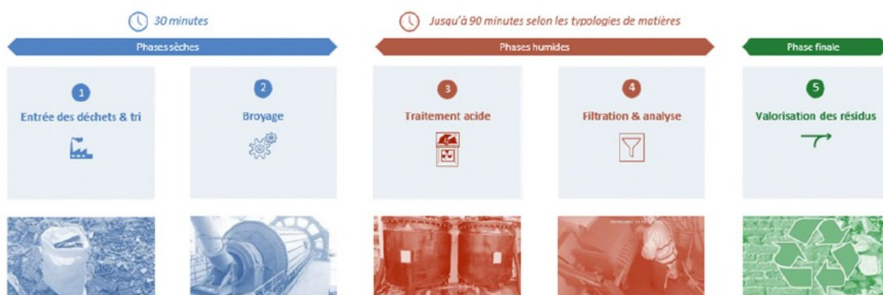
Principales étapes de traitement des déchets pris en charge (source: résumé non technique de l'étude de dangers, page 10)
