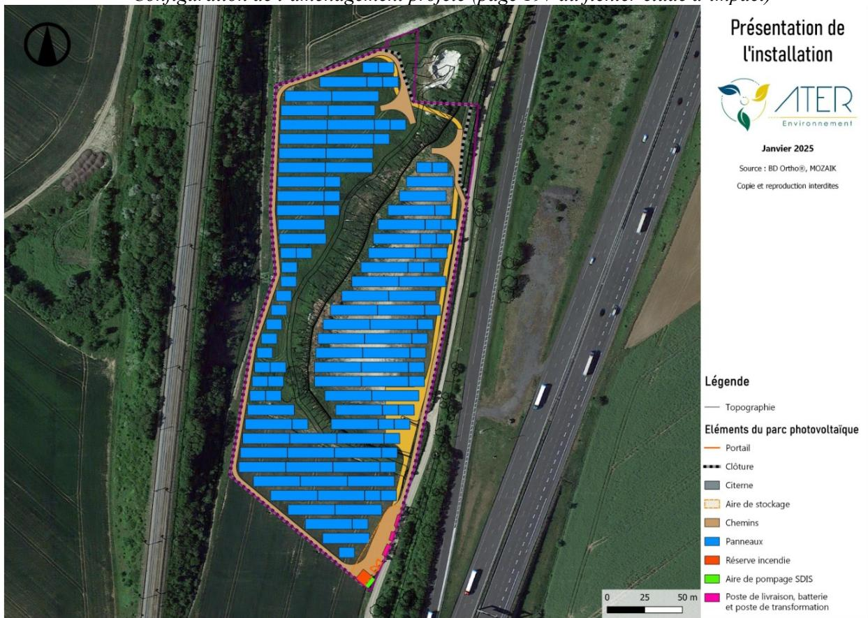
L'installation sera composée de 119 tables de panneaux photovoltaïques, pour un total de 6 723 modules d'une puissance unitaire d'environ 640 Wc et d'une surface unitaire de 2,7 m<sup>2</sup>. La technologie utilisée par les modules n'est pas encore arrêtée, considérant les évolutions technologiques pouvant intervenir.
