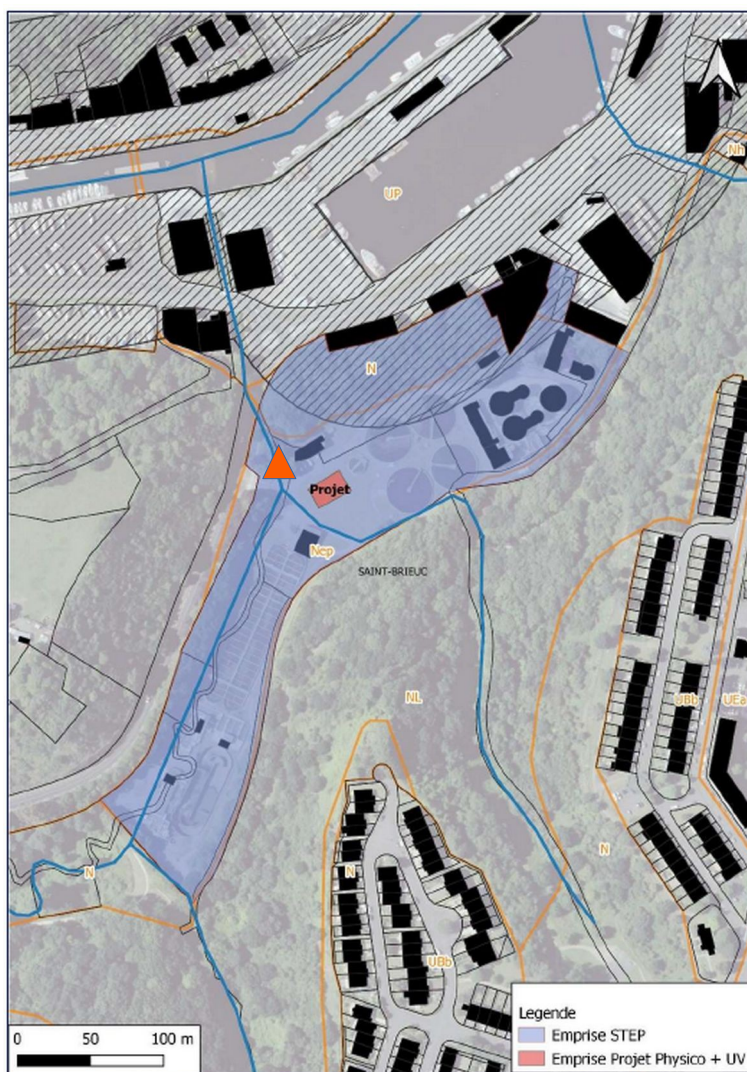
Figure 3 : Extrait du dossier (volume 2) localisant l’emprise des nouveaux équipements (rectangle) et situant le point de rejet des eaux traitées, inchangé (triangle).
