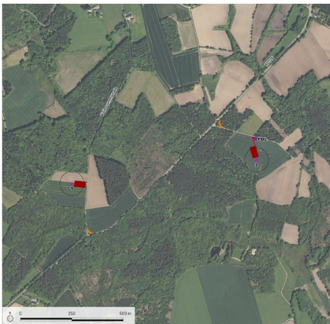
Figure 2: Localisation des éoliennes, de la surface balayée par les pales, du poste de livraison, des chemins d'accès et des aires de grutage (source : étude d'impact)
