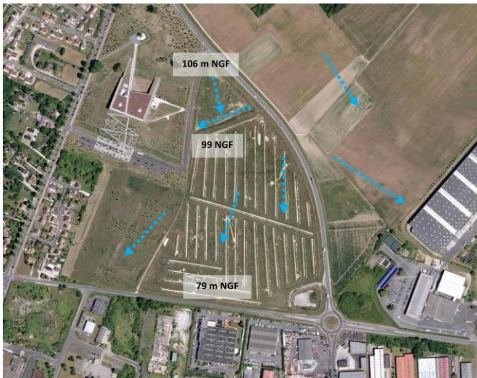
Illustration n°5 - Écoulement des eaux de surface (source : étude d'impact p.36)
