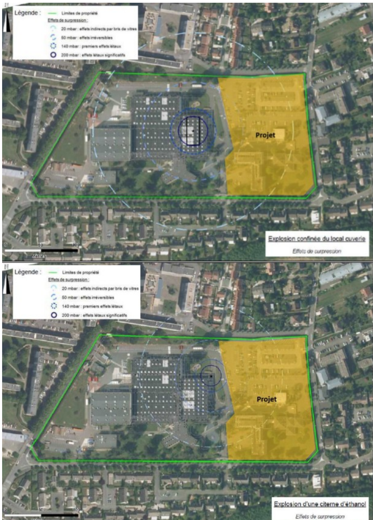
Illustration 5: Cartographie des zones d'effets de l'établissement FAREVA (étude d'impact page 71) Légende des cercles (de l'intérieur vers l'extérieur) 20 mbar : effets indirects par bris de vitre ; 50 mbar effets irréversibles ; 140 mbar : premiers effets létaux ; 200 mbar : effets létaux significatifs.
