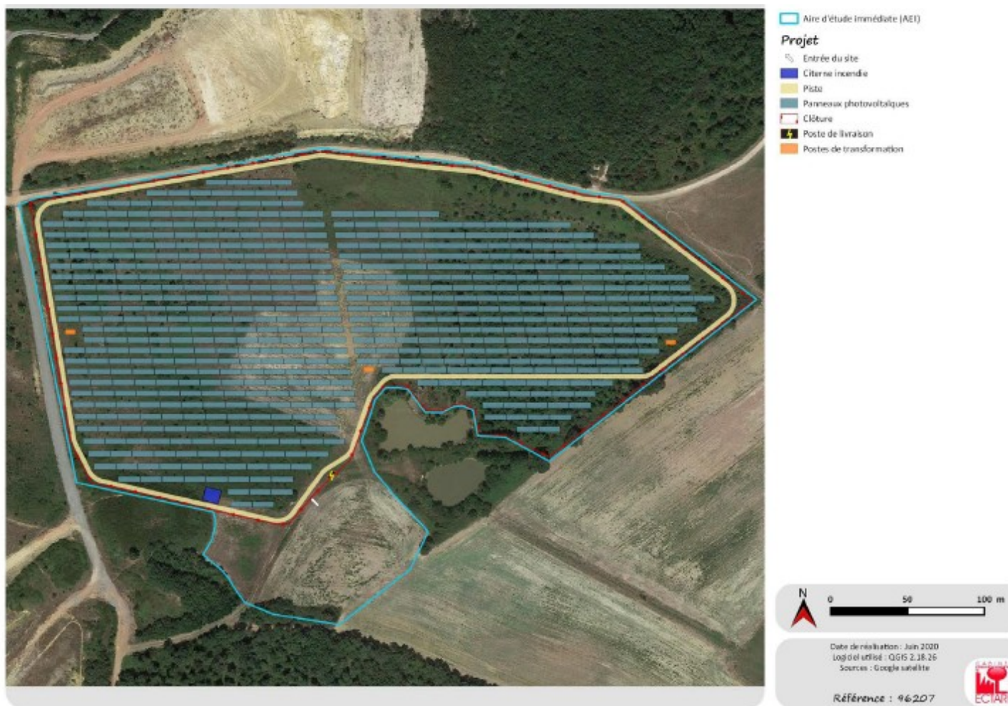
Figure 2 : plan des principaux éléments constituant le parc photovoltaïque
