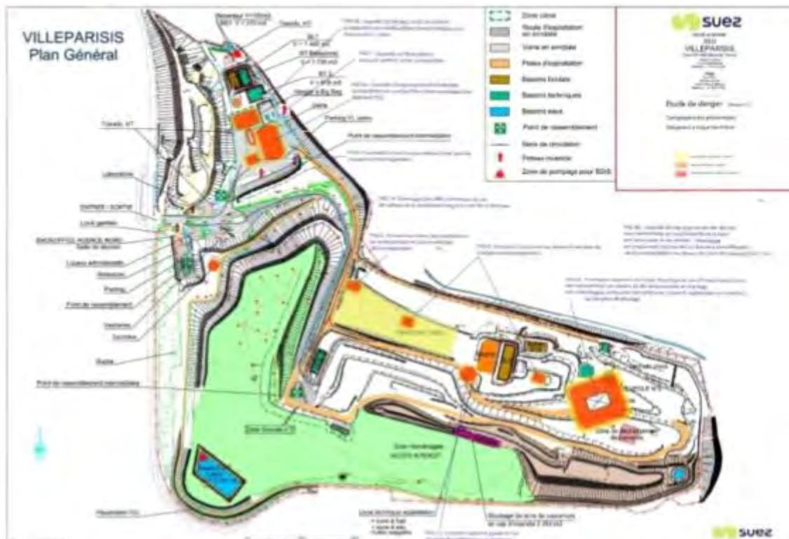
Figure 5 : Risques thermiques de l'ISDD modifiée (centre des aires d'impact en orange)- Source : étude d'impact (p 194)
