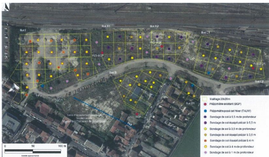
Figure 4: Plan de situation des sondages du diagnostic pollution sol/eaux (source : étude d'impact)
