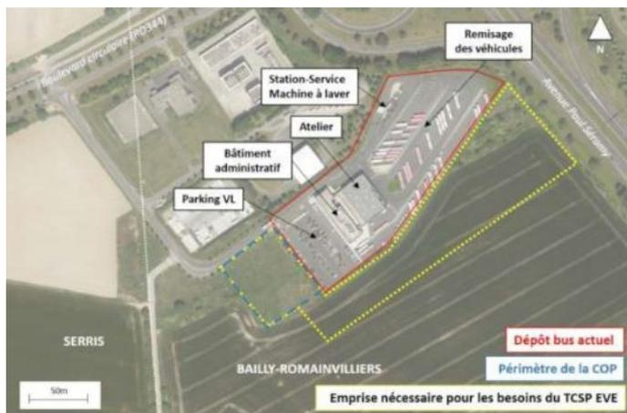
Figure 4: Site de maintenance et de remisage existant et emprise de l'extension prévue dans le cadre du projet (E2, p. 131)
