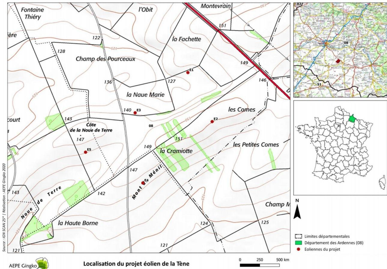
Le parc éolien de la Tène sera constitué de 5 éoliennes accompagnées de 5 plateformes utilisées comme aires de grutage, d'un réseau de voies d'accès, de 2 postes de livraison électrique et d'un câblage électrique souterrain entre les éoliennes et les postes de livraison.
