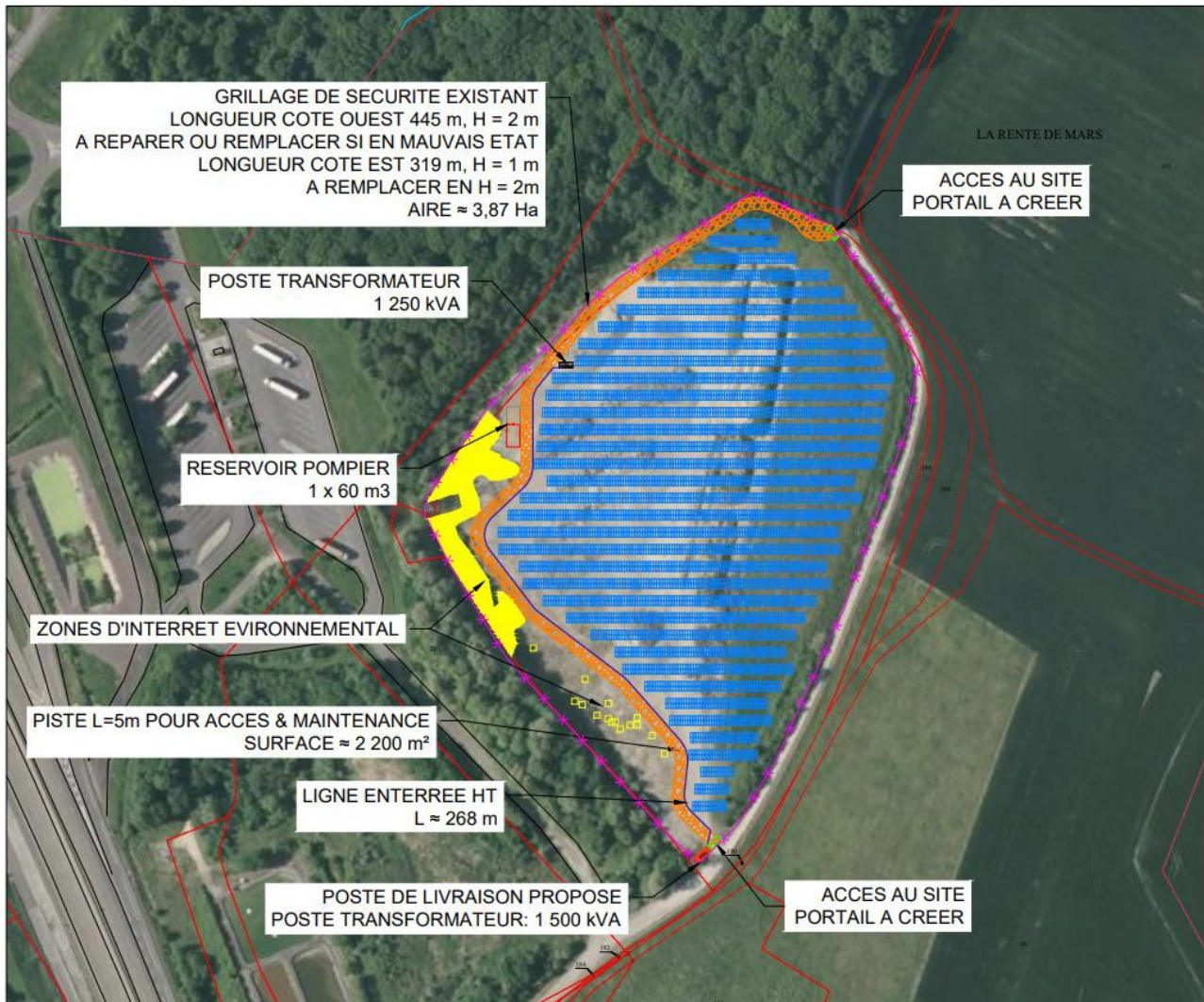
Plan de masse du projet (tiré de la description du projet, page 34 de l'étude d'impact)
