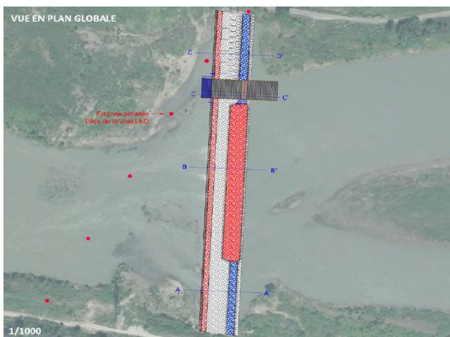
Figure 3: Vue en plan du seuil 68 réaménagé (à titre d'exemple) – en rouge échancrure centrale ; en gris rampe à macrorugosités - Source : étude d'impact
