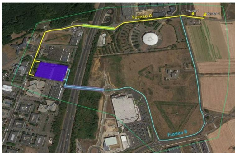
Figure 5: Localisation du site du projet par rapport au point de piquage et tracés envisagés pour la liaison souterraine de raccordement - Étude d'impact p. 36.
