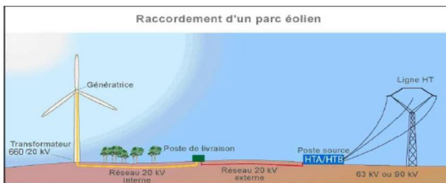
Figure 5: Schéma de principe du raccordement électrique au réseau de distribution ( résumé non technique, p. 9)
