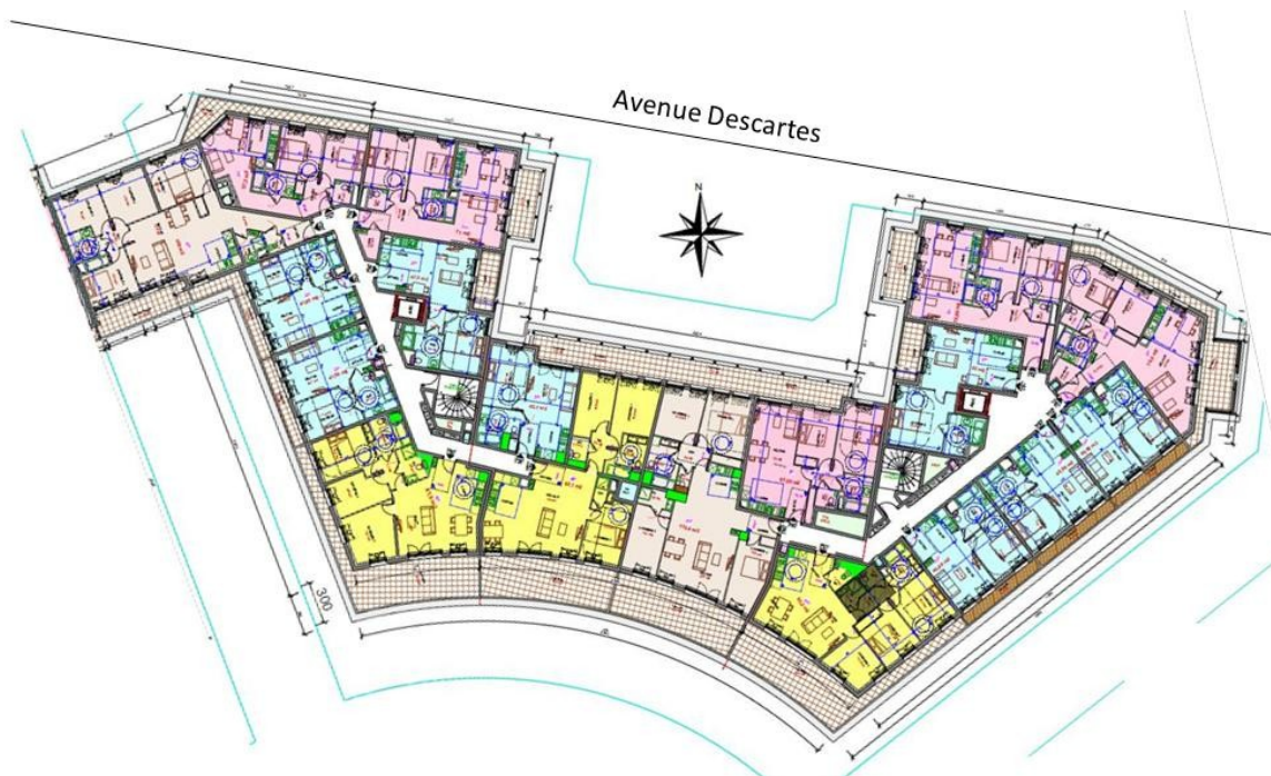
Figure 7: Plan du niveau R+4 du bâtiment 2 situé le long de l'avenue Descartes (source : pièce AN3b du permis de construire). On constate que cet étage courant comprend une majorité de logements mono-orientés, dont quatre ont des chambres directement exposées sur l'avenue Descartes.
