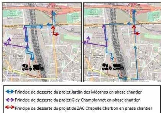
Figure 21 : Schémas des principes de desserte des engins de chantier (source : étude d'impact, p. 320)
