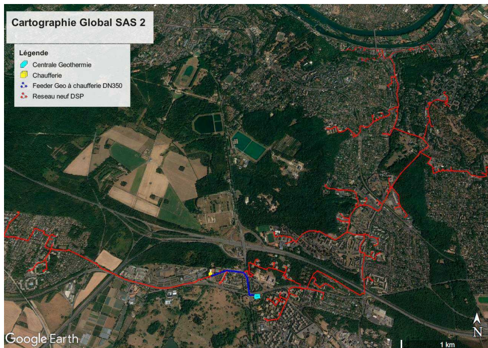
Figure 6: Cartographie globale du nouveau réseau SAS 2. En bas, au centre de l'image, emplacement de la centrale géothermique (point turquoise). Source : Étude d'impact, p. 61.
